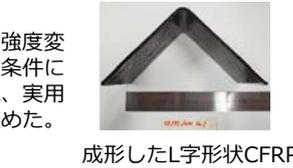
金属/複合材接合構造の熱変形挙動を画像相関法によるひずみ計測により調査し, 全体変形に及ぼす各部の影響を調査した。
