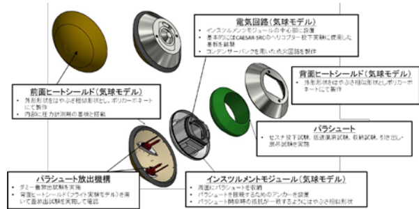
図6: 気球実験用SRCの概念図 (重量 45.5kg)
