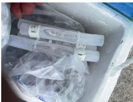
図3 宮古島放球試験での微生物格納モジュール
