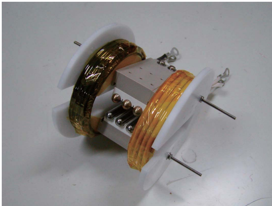
図4 直交外部磁場印加2次元MPD実機写真 (9ターン Helmholtz コイル実装時)
