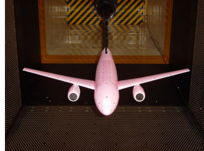
図 4: 複合 PSP 塗装された DLR-F6 模型 © JAXA
