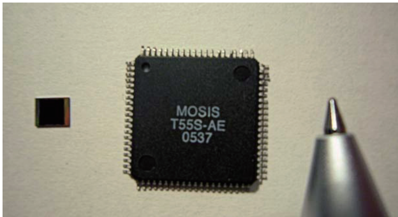
図 5: 試作したアナログ ASIC. 左がベアチップ、右が 80pin パッケージ.
