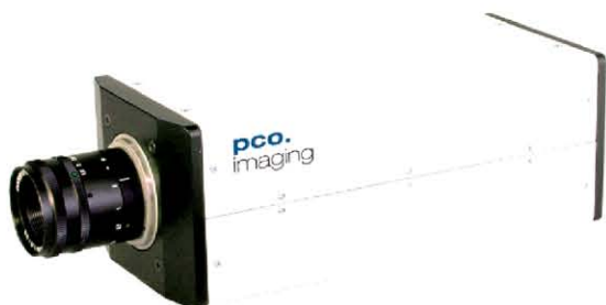
図1 マルチゲートカメラ SensiMod (PCO 社カタログより引用)。本体に 12bit A/D コンバータが内蔵されているため小型である。CCD 冷却中、冷却後の消費電力は、それぞれ 36W、22W であった。データは光ファイバを経由して、専用の PCI ボードに転送される。
