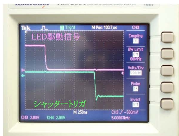
図3 トリガボードの出力波形(左:横軸目盛=50 μs)と拡大図(右:横軸目盛=250ns)。PtOEP を励起するために、LED 駆動信号として 5kHz の方形波を出力する。シャッタートリガのデューティ比は 84.375%で、LED オフから 1.25 μs 後にトリガ信号が 5V から 0V になる。そして 31.25 μs 後に、トリガ信号は再び 5V となる。それぞれの信号立ち下がり時間は 100ns 以下であった。
