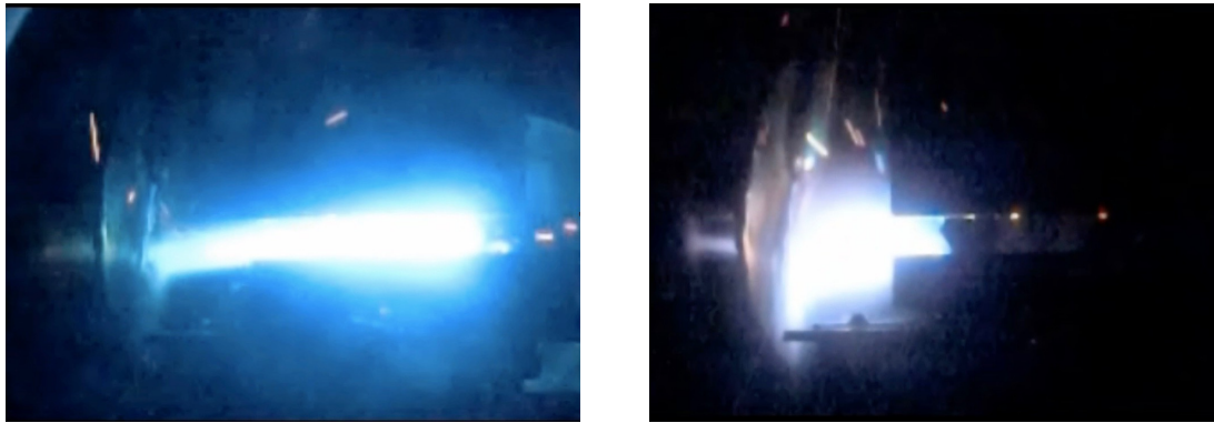
図4 側面から見た放電。左：A-mode (上下電極の間でのプラズマ噴出)。右：B-mode (電極端からのプラズマ噴出)。
