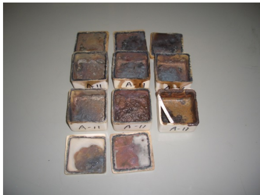
図 1 一次焼結した A11 モデル
