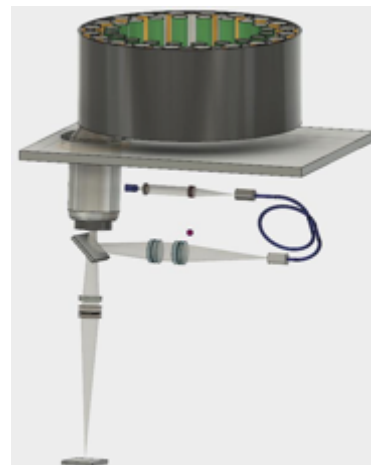
図4. LDM装置のコンセプト図。ローバーからの試料を受け取る試料皿が上部のローターに20配置されている。LDからの励起光は対物レンズを通して試料を下から照射、蛍光を撮像素子で撮像する。
