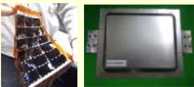
高性能電源系機器の外観 薄膜太陽電池セル(左)とSUSラミネート型バッテリーセル(右)
