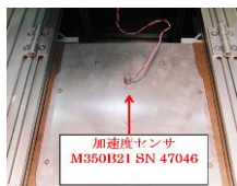
加速度センサを取り付けた試験板
