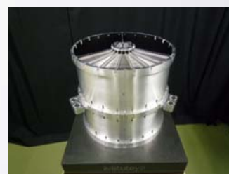
図4: 1セグメント分が完成した FFAST HXT。
