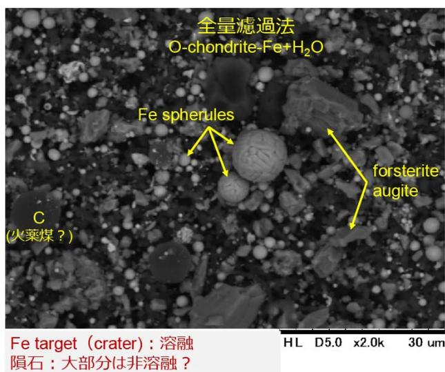
図 1、隕石—水衝突実験後に水の全量濾過で回収された微粒子。海底には金属鉄のターゲットを固定し、クレーターが形成した。
