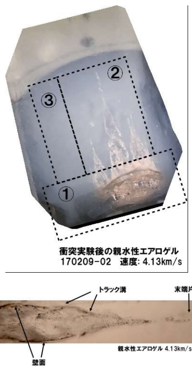
図3: 0.01g/cc 親水性エアロゲルに捕集されたペプチド含有シリカ粒子が形成したトラック
