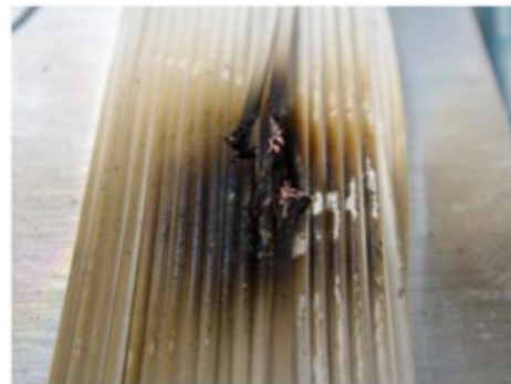
図 1 微粒子の超高速衝突により溶断・炭化した模擬衛星電力ハーネス.
