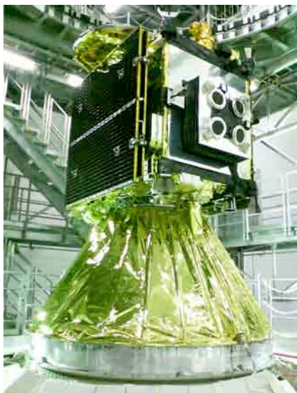
図5 打上直前の「はやぶさ2」小惑星探査機（2014年11月、種子島宇宙センターにて）。円錐形のPAF（Payload Attach Fitting）の上に搭載された探査機。4台のイオンエンジンが見える。
