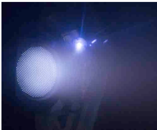
図2 マイクロ波放電式イオンエンジンのプラズマ噴射。多孔グリッドからイオンが高速噴射され、右斜上の中和器から電子が供給されている。
