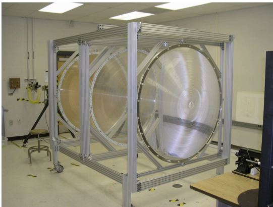
図 3. 製作した中央部分光学系の写真 出来上がった中央部分の 3 枚組みレンズセットは、米国にて性能評価を実施されている。
