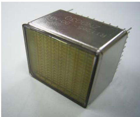
図 4. 8x8 画素を持つ位置検出型光電子増倍管 M64
