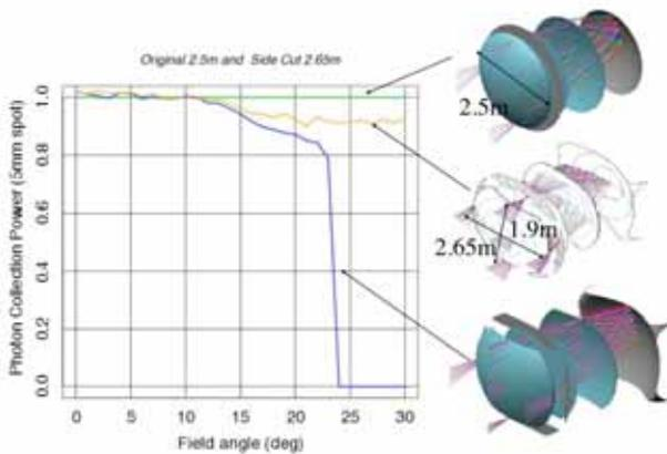
図 5. 側方カット光学系の性能
