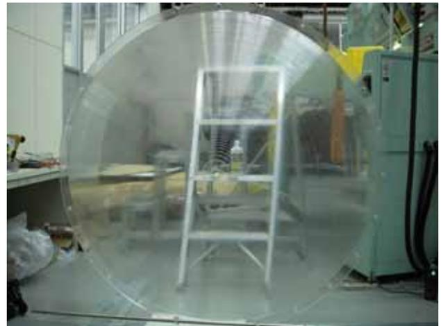
図 10. 試作した第 3 レンズ中央部分（直径 1.5m）の試作結果。この写真は洗浄前に撮影したもので、レンズ表面にはまだ切削屑と切削オイルが付着している。
