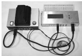
図 1 2. 両肘屈伸用インテリジェントスーツ。電源と刺激装置を分離，小型化し，ウエストのバッグにそれぞれの装置を装着，電線はスーツに組み込む。スーツの生地は抗菌，防臭，保温に優れる生地を使用。
