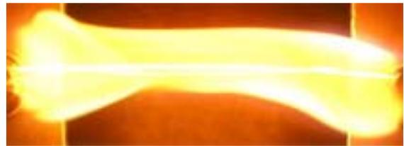
図4 電線の短絡による被覆の着火(図2と同一試料,
