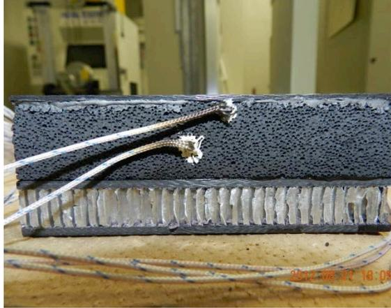
(b) 赤外線ランプ加熱試験用 100mm 角 NALT 試験片，断熱材 B(発泡カーボン)を使用
