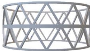
図1 ラティス円筒構造
