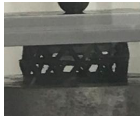
図 18 観測した座屈波形
