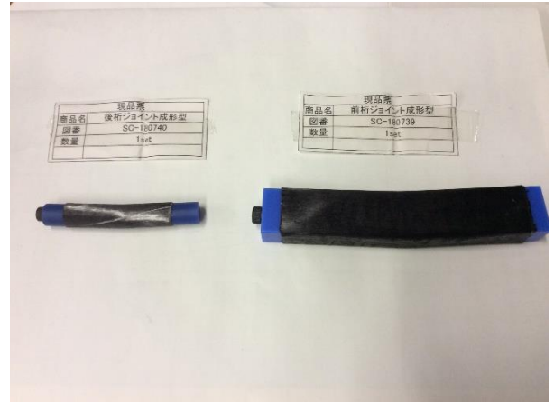
図6 CFRP を巻き付けたジョイント型
