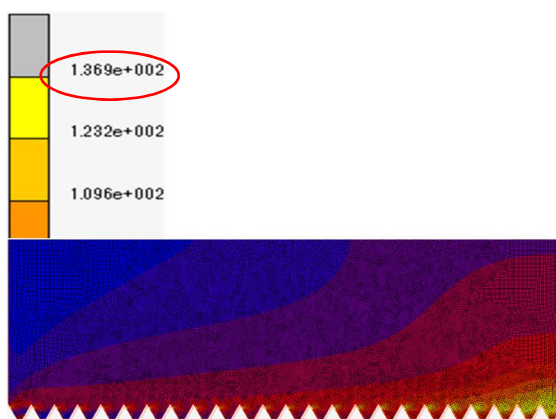
図8 ベークライト (M6 4d 解析/試験=77.6%)
