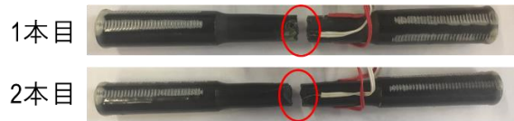
図 2 試験片破断後の様子
