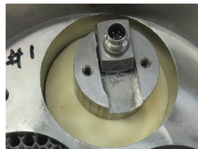
Fig.5 試験前の発泡ウレタン材料
