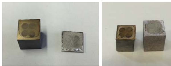
図 3-3 ぬれ性評価結果 (直接ろう接) 左：Au-3Ni-0.5Ti、右：Au-3Ti-1.5Ti
