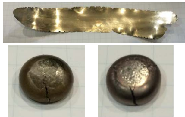
図 3-1 製作したろう材 上 : Au-3Ni-1.5Ti 左下 : Au-3Ni-3Ti 右下 : Au-6Ni-6Ti
