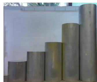
図 1 アルミ円柱試験体
