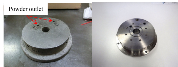
図6 EBM造形後の噴射器(図左)、造形後に機械加工を実施した噴射器（図右）
