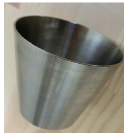
図8 EBM後に機械加工を実施したコンカルノズル
