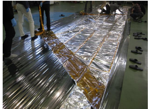
図7 ハーネス搭載後の試作セイル
