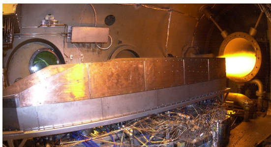
図 9 RBCC 燃焼試験 (M0 条件)
