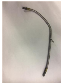
図16 曲がった固定ボルト
