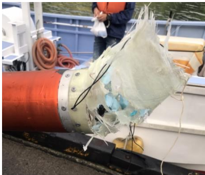
図 10 計測モジュール破損の様子
