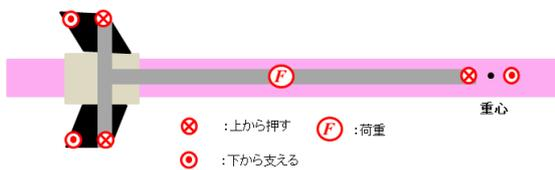
第14図 剛性試験上面図(機体胴体込み)
