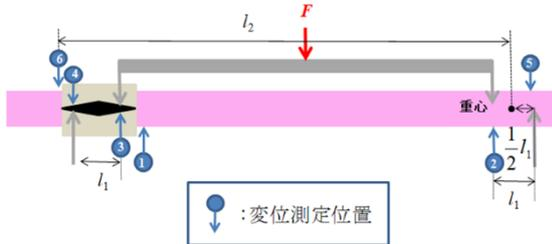
第13図 剛性試験変位測定位置(機体胴体込み)
