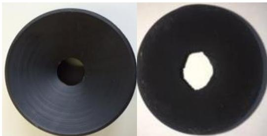
第1図 ベークライト製ノズル(左: 燃焼前 右: 燃焼)
