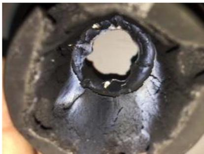
第5図 燃焼後の世界最強磁器製ノズル
