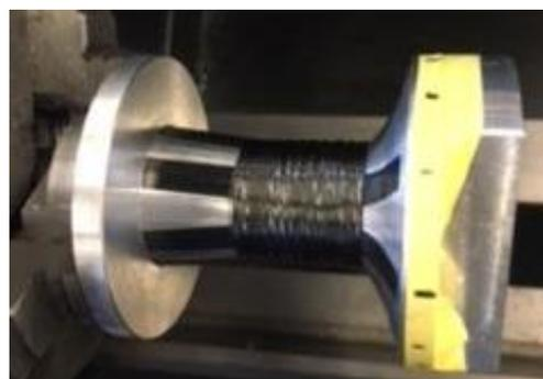
第 4 図 金型にプリプレグを巻き付けている様子
