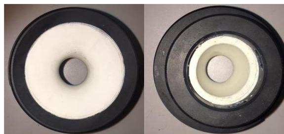
第 3 図 2017 年度開発ノズル(世界最強磁器製)
