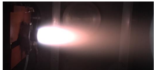
図12 推力測定時の噴射の様子
