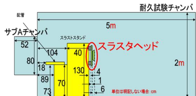
図4 チャンバ内のスラスタヘッド設置状況
