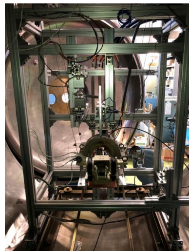
図4 スラストスタンド正面の写真
