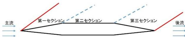
図10 フィンに発生する衝撃波と膨張波
