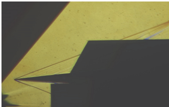
図 12 可変インテーク周囲流のシュリーレン写真
