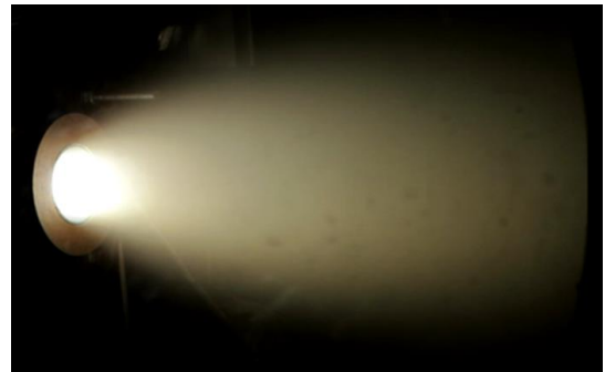
図 12 SHP163 分解ガスでの噴射
