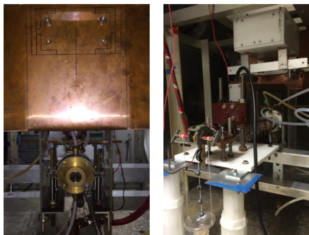
図10 推力測定装置
