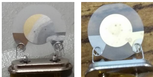
図6 内部挿入QCM (左:壁面側, 右:アンテナ側)
