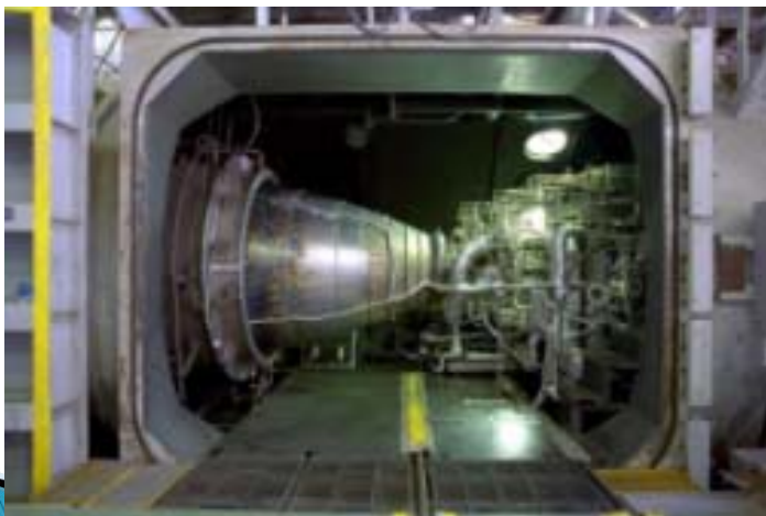
LE-5B-2エンジン開発試験 (於角田宇宙センター 高圧燃焼試験設備)
