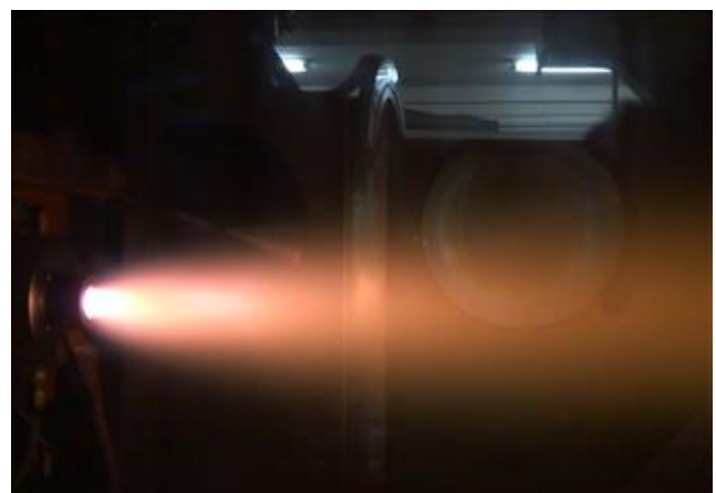
図 19 窒素単体での噴射の様子(アノード輻射冷却式)
