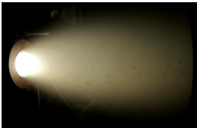
図 13 SHP163 分解ガスによる噴射の様子(水冷式)
