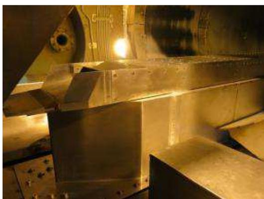
図 2 マッハ 4 風洞実験用エンジン供試体
