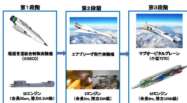
図 3 極超音速飛行実験構想
