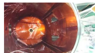
図 18 フィルムを内側に張り付けたチャンバ内の様子
