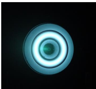
図 3 アノードレイヤ型ホールスラスト作動時
