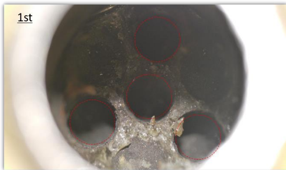
図 13 燃焼試験後のスラスタ#2(1回目)の内部
