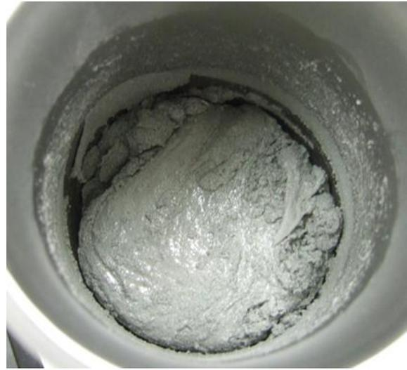
図8 攪拌後の推進薬の状態(条件1)
